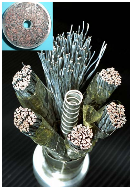
Figura 5 - Conduttore per le bobine prototipo di ITER
