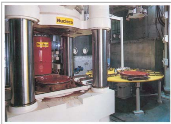
Figura 20 - Impianto di supercompattazione ICS 42
