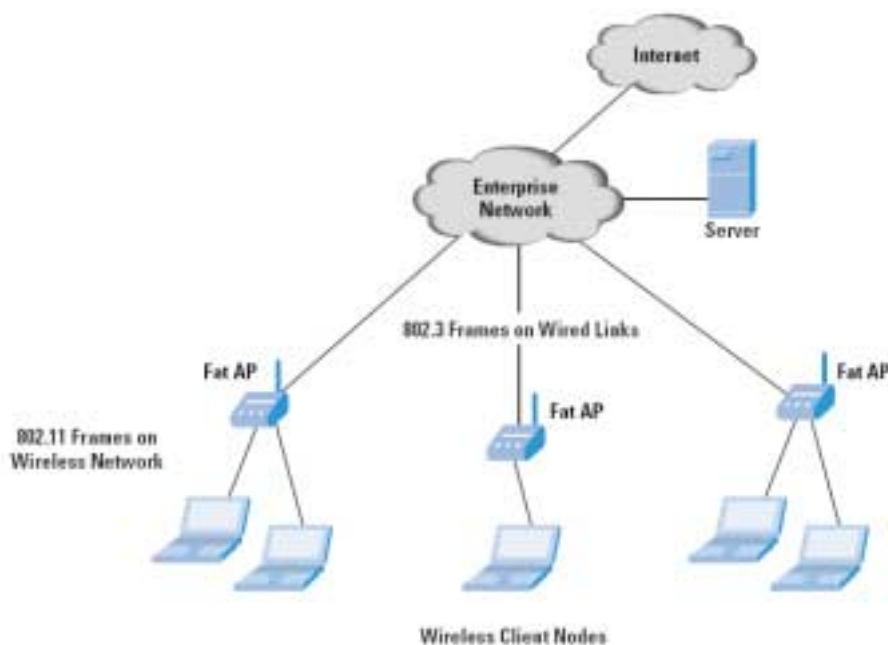
Figura 5.8 - Architettura di rete WLAN con apparati autonomi.
