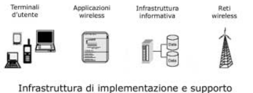
Figura 4.2 - Soluzione wireless articolata in componenti.
