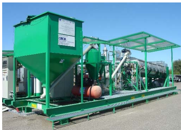
Figura 8 - Impianto pilota SICAV a tamburo rotante situato nel Centro di Ricerche ENEA-Trisaia
