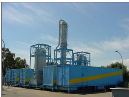
Figura 11 - Impianto DEDALO per il trattamento di percolati di discarica
