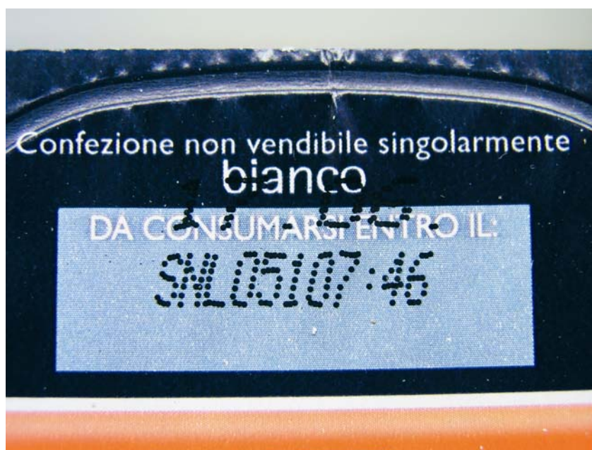
Foto n. 7 (scheda 92) corrispondente ad un crema di yogurt. Presenta scritta deformata e non integra, con insufficiente contrasto. Inoltre la data è collocata al di fuori del campo predefinito.
